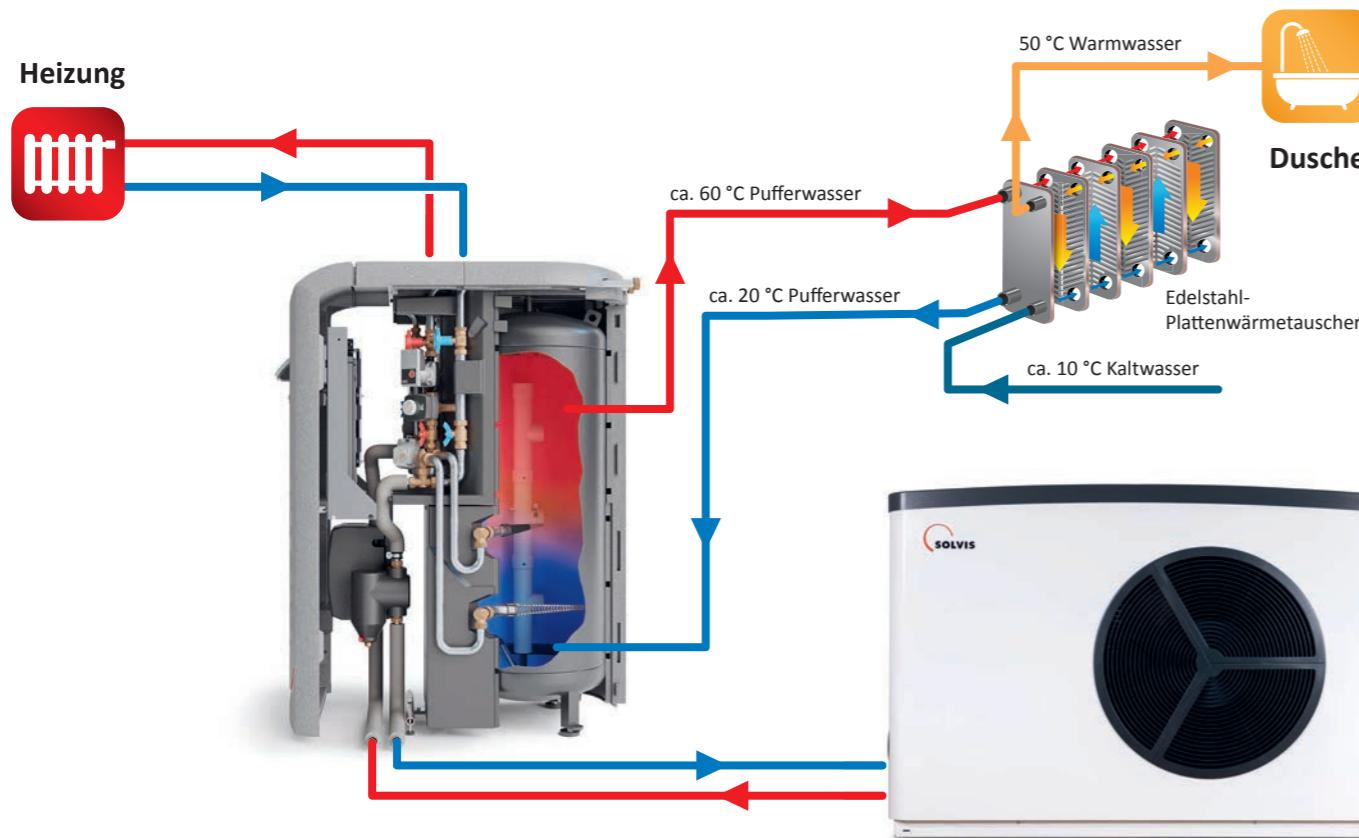
Heizkreislauf mit Wärmepumpe SolvisLea und Pufferspeicher SolvisBen mit 230 l.
