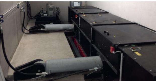
Massive Hydraulikzylinder zur Schubbodenbewegung
