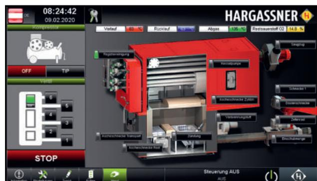
Funktions- & Relais test für alle Sensoren und Motoren
