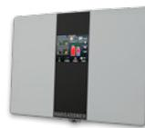
**Heizkreisregler HKR mit Touch:** Der HKR ist ein witterungsgeführter Außentemperatur-Regler mit Touch-Bedieneinheit. Der Regler sendet der Heizungsanlage die Information, ob eingheizt werden soll oder nicht. So kann die Raumwärme mit max. acht Heizkreisen und fünf Boilerkreisen geregelt und konstant gehalten werden. Diese Automatik sorgt unter anderem für einen energiesparenden Heizbetrieb. Auch ein „standalone Betrieb“ ist möglich.
